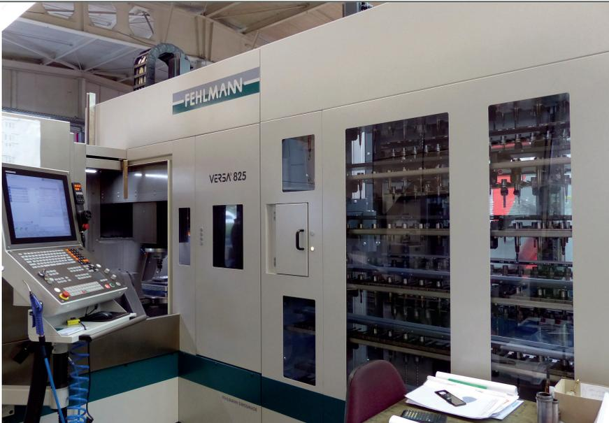
**Automatisiertes 5-Achs-BAZ:** Die Anlage von Fehlmann bewältigt die gewünschte Ausbringung problemlos, dazu trägt auch der große Werkzeugvorrat von 218 Plätzen bei
